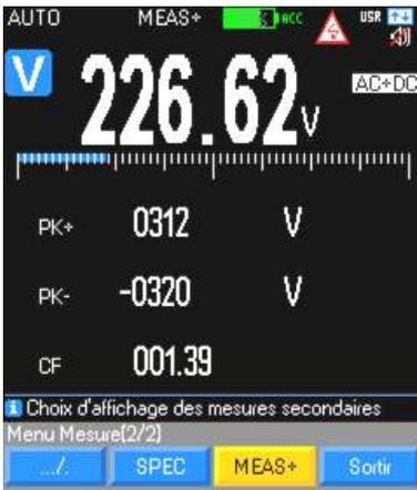
Messbereich 100mV ist nur im MANUAL Modus vorhanden, über **Range**. Auf jeden Fall erscheint "O.L" ab 1050V und bei Messungen über 600V erklingt ein Signalton. Das Symbol für Gefahrenspannung wird bei "V" über 60 VDC bzw. 25 VAC angezeigt.
