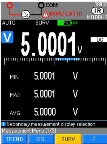
Der **SURV**-Modus (Zugriff über **MEAS...**) überwacht die Schwankungen eines Signals, indem die **MIN**- und **MAX**-Werte der Hauptmessung aufgezeichnet werden und der Mittelwert **AVG** berechnet wird.
