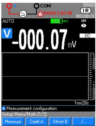
• Mit der Funktion
