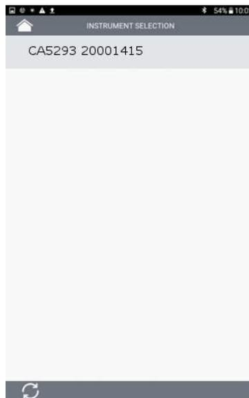
Aktivieren Sie die Bluetooth-Funktionalität und das MODBUS-Protokoll auf dem Multimeter. Die Verbindung wird durch Drücken des Gerätenamens eingeleitet, sobald dieser angezeigt wird.
