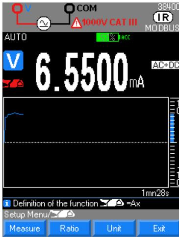
1. Zuerst muss die Zangen-Funktion aktiviert werden. Je nachdem, welche Zangentypen angeschlossen sind, drücken Sie zwei Mal auf "Zange" bzw. über das Menü Setup/Zange die Kopplung fest.
