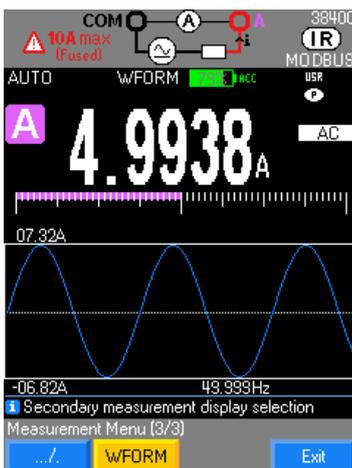
Bei einer Wechselstrommessung lässt sich die Wellenform von Signalen von 10 Hz bis 600 Hz mit der Funktion **wFORM** anzeigen.
