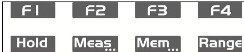
Die Tasten reagieren sofort beim Drücken. Ein Signalton zeigt an, dass der Tastenbefehl berücksichtigt wurde. Die aktiven Tasten sind bei langem Tastendruck mit “...” gekennzeichnet: **Meas...**, **Mem...**, **Setup...**
