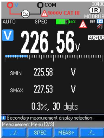
Ausgehend von den technischen Gerätespezifikationen zeigt der Modus **SPEC** die Toleranz der aktuellen Messung direkt an; kein Suchen und Berechnen erforderlich.
