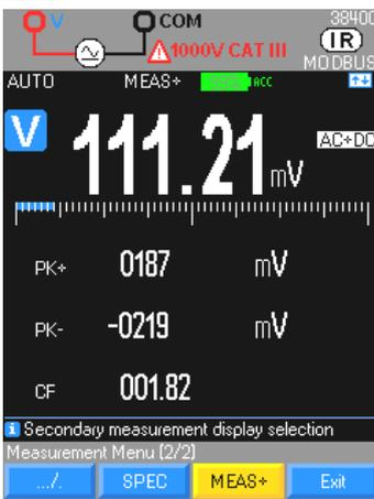
Rasche Peak-Messungen sind in den Sekundärmessungen **MEAS**, **MEAS+**, **PK+** und **PK-** für folgende Messfunktionen verfügbar: V und A (AC, AC+DC); Integrationszeit unter **250 µs**.
