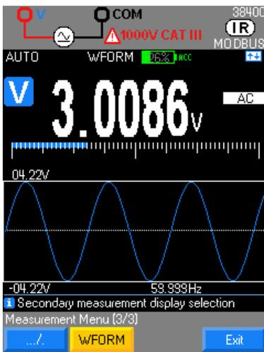
Bei einer Wechsellspannungsmessung lässt sich die Wellenform von Signalen von 10 Hz bis 600 Hz mit der Funktion **wFORM** anzeigen.
