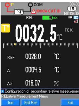
Temperaturmessung mit einem Thermoelement zwischen 2 V-Anschlüssen und COM in °Celsius
