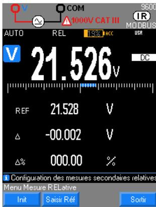
Im Modus "DC" messen Sie den Wert einer Gleichspannung oder der Gleichkomponente einer Wechsellspannung.
