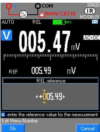
Dieser Modus zeigt an, dass sich der angezeigte Wert auf einen Referenzwert bezieht. Er ist für die folgenden Messfunktionen verfügbar: V, Hz, Ohm, Zange, Kapazität, Temperatur und Strom.
