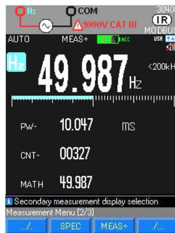
Messen der Impulsbreite in ms gemäß den Triggerbedingungen des Frequenzmessers
