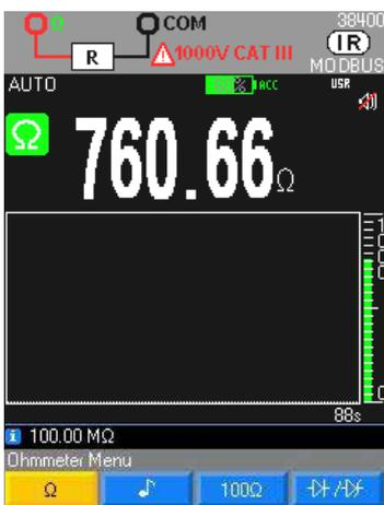
Im Messbereich 50 M $\Omega$  empfiehlt es sich, das Multimeter vom Wall Plug zu nehmen, um eine Beeinflussung durch das Netz auszuschließen und die genannten Spezifikationen zu gewährleisten und Störgrößen zu vermeiden.
