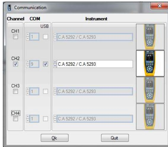
Bei einigen Bluetooth-Adaptern muss zum Bestätigen der Verbindung der PC neu gestartet werden. Die Verbindungsparameter sind für jedes Multimeter spezifisch. Sie müssen manuell zugeordnet werden, allerdings nur beim ersten Mal.
