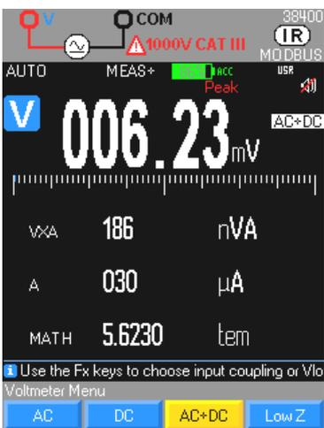
Am COM-Eingang muss die Verbindung möglichst kurz und mit großem Durchmesser angelegt werden, um Spannungsabfall zu vermeiden, der die Volt-Messung beeinträchtigen könnte.
