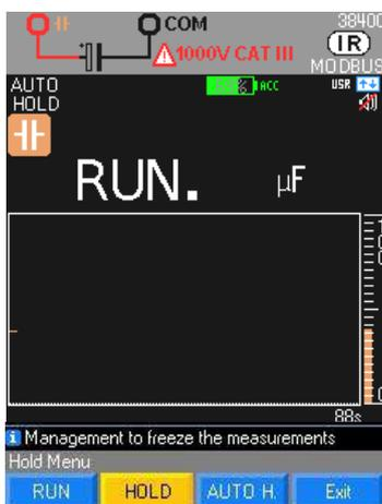
Kapazitätsmessung eines Kondensators in Auflösung 1000 Digits
