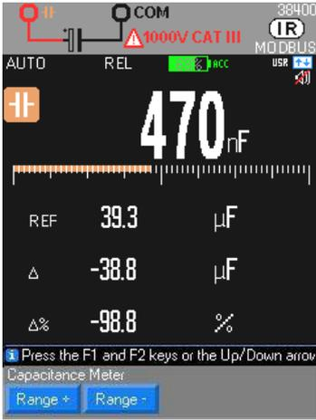
Automatische Bereichswahl AUTO (standardmäßig) oder manuell Range + oder Range - "Aktiver" Schutz durch Thermistor CTP
