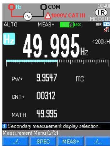
Berechnung der positiven bzw. negativen Impulse gemäß den Triggerbedingungen des Frequenzmessers
